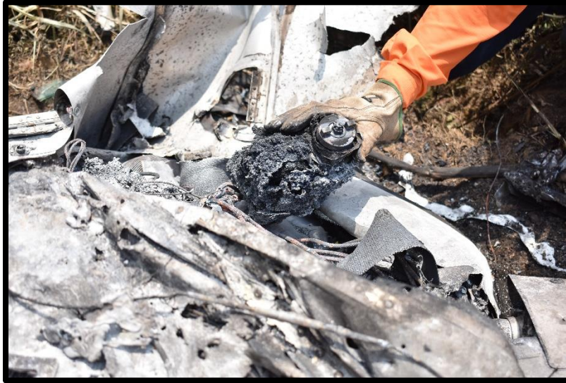
Fotografía No. 25 Vista de uno de los magnetos del motor.
