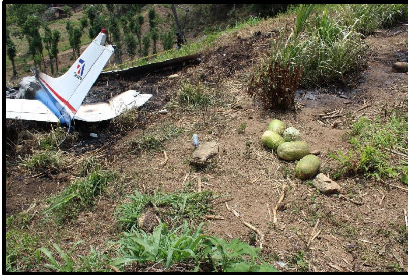
Fotografía No. 9 En el lugar del impacto, No se observaron marcas de desplazamiento del fuselaje.
