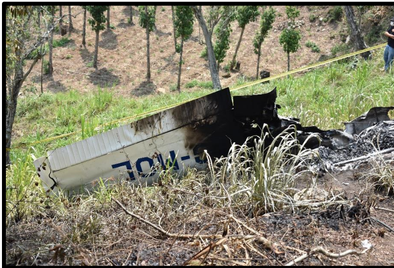
Fotografía No. 8 Vista de los restos del ala izquierda de la aeronave.
